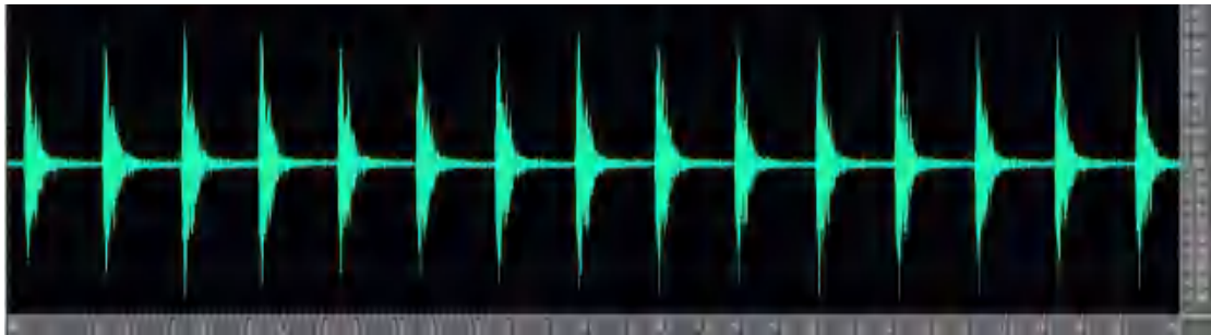
图 6.1-30 测点 1 采集到的多个打桩脉冲的时域波形
