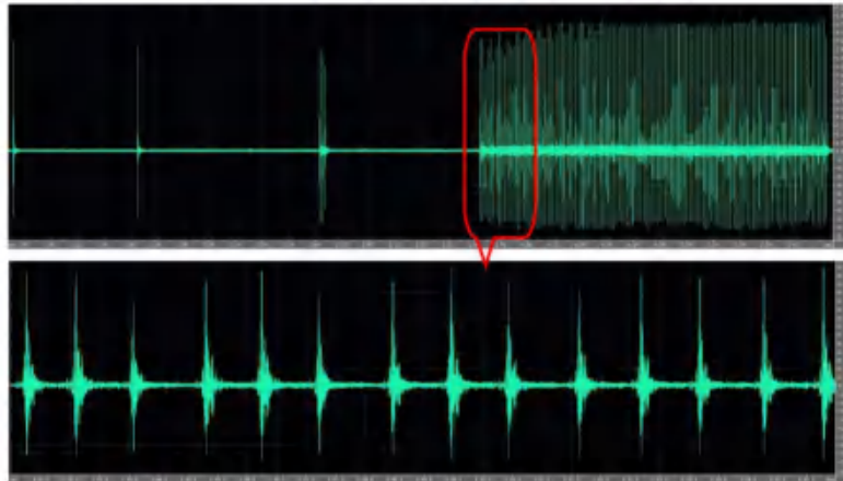
图 3.4-18 多个打桩脉冲波形
