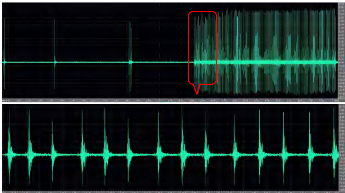
图 6.1-39 多个打桩脉冲波形
